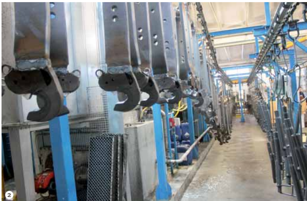
Figura 2: Il trasportatore monorotaia conduce i cilindri idraulici lungo la linea di pretrattamento e verniciatura.
