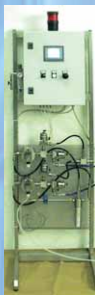
Sistema automatico di miscelazione delle vernici liquide pluri-componenti con metodo proporzionale
